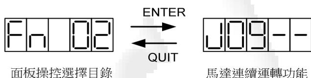
“馬達連續運轉”功能提供使用者不外接任何控制器，在CSBL980面板上即可控制馬達正反旋轉的能力。
