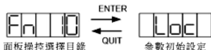
“參數初始設定”會將CSBL980所有系統參數重設成出廠時的預設值。一旦執行就不易回復，為防止使用者在不注意的情況下誤用此功能，CSBL980有多一道防護機制。使用者必須先以FN 10功能解除系統閉鎖狀態，才能執行本功能。
